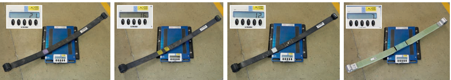
1 Für Ducato und Co. gibt es für Light-Chassis ab Werk verschiedene Blattfedern mit unterschiedlichen Federraten. Die schwerste ist eine Doppelblattfeder mit 21 kg Gewicht je Seite. 2 Weit verbreitet ist die härtere Einzelblattfeder. Diese wiegt immer noch 16 kg. 3 12 kg wiegt dagegen die weichere Variante der Einzelblattfeder. 4 Die GfK-Feder des Route-Comfort-Sets wiegt dagegen nur sieben Kilogramm.
