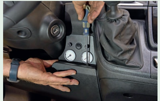
9 Hier lässt sich später der Luftdruck für beide Federbälge getrennt einstellen.
