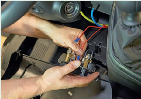
8 Die Steuereinheit der Luftfeder findet ihren Platz rechts unter dem Lenkrad.
