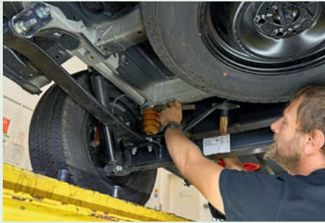
2 Die orangen Anschlagpuffer müssen weichen. Hier ist etwas sanftere Gewalteinwirkung nötig.
