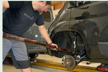
3 Mit einem langen Hebel wird der Dämpfer aus seiner Aufnahme gestemmt.
