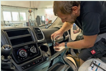
1 Ein Stoßdämpferwechsel beginnt beim Ducato kurioserweise mit Schrauben am Armaturenbrett.
