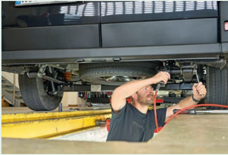
1 Die Blattfedern hängen nur an zwei Aufnahmepunkten, deren Verschraubung gelöst wird.
