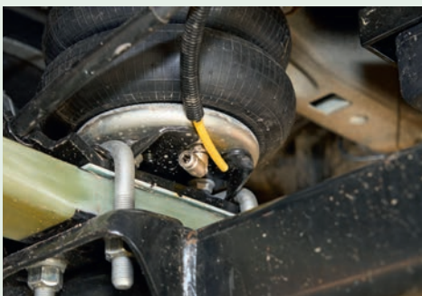
10 Nachdem alle Luftschläuche sorgfältig verlegt sind, erfolgt der Anschluss an die Federbälge.
