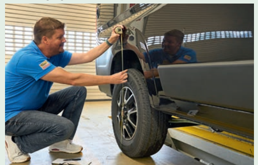
12 Voll aufgepumpt steht der Wagen etwa sieben Zentimeter höher.
