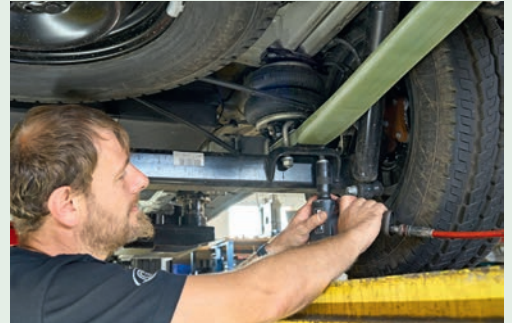
6 An der Achse befestigt man die Feder an den Original-Aufnahmen mittels zweier Bügel.
