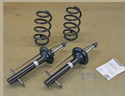
Das Route-Comfort für die Vorderachse besteht aus einer neu abgestimmten Feder-Dämpfer-Kombination.
