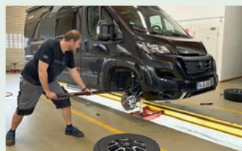
7 Zu guter Letzt wuchtet man den Dämpfer in die untere Aufnahme an der Vorderachse.
