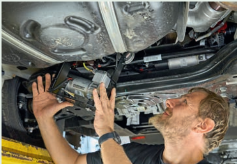
7 Der Kompressor wird mittels passender Aufnahme zwischen Vorderachse und Tank montiert.
