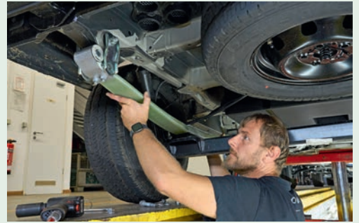
3 Ist die alte Feder raus, hebt man die leichte und weichere GfK-Blattfeder in die Aufnahmen.
