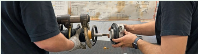
1 Ein Stoßdämpferwechsel beginnt beim Ducato kurioserweise mit Schrauben am Armaturenbrett.
