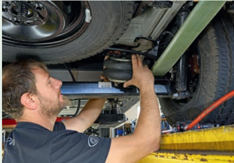
5 Dann wird der Federbalg zwischen Achse und Karosserie geschoben.
