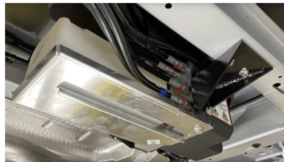
Das Hydraulikaggregat der HLC® Smart wurde speziell für die Unterflurmontage konstruiert.
