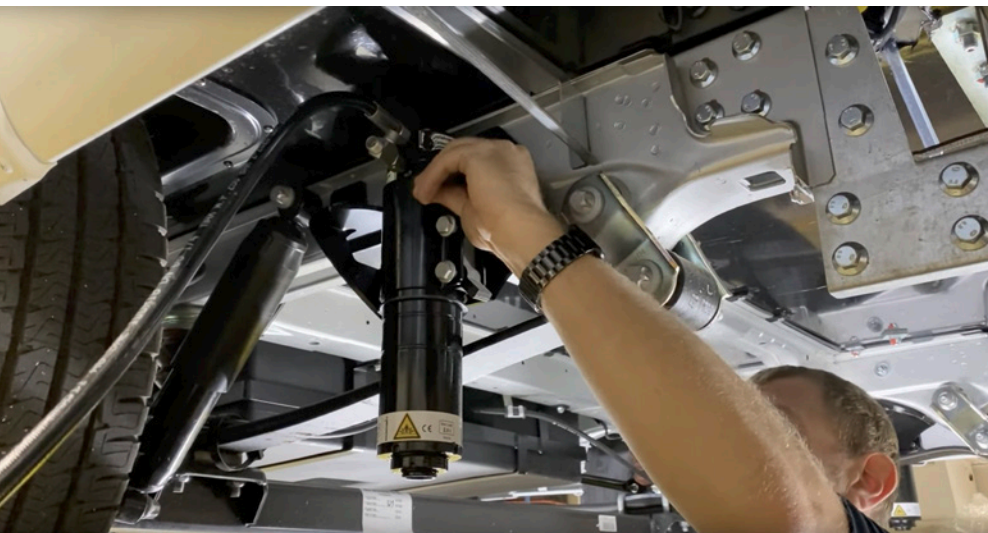
Die Hydraulikzylinder werden mit speziellen Konsolen am Fahrzeugrahmen befestigt.
