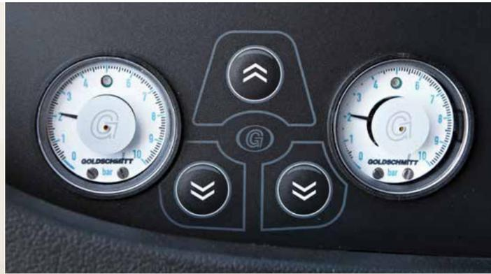
Über ein im Armaturenbrett installiertes Bedienteil lässt sich der Luftdruck in beiden Bälgen getrennt anpassen.
