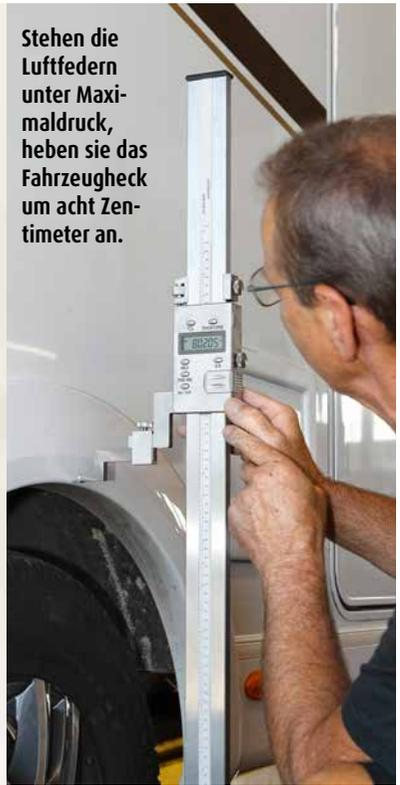
Stehen die Luftfedern unter Maximaldruck, heben sie das Fahrzeugheck um acht Zentimeter an.
