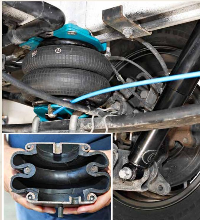
Die Zusatzluftfeder wird zwischen Blattfeder und Fahrzeugrahmen montiert. Der Schnitt zeigt den Aufbau des luftgefüllten Gummibalgs.
