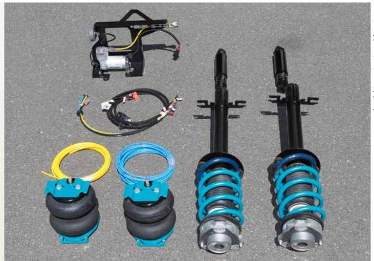
Neue Komponenten: Zusatzluftfedern (v. l.) mit Kompressor (h. l.) für die Hinterachse, Route-Comfort-Federbeine (v. r.) für die Vorderachse.
