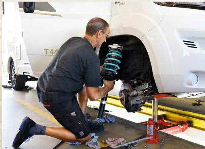
Das neue Federbein wird von unten in den Radkasten geschoben. Verschraubt wird es von innen hinter der Armaturenbrettverkleidung.
