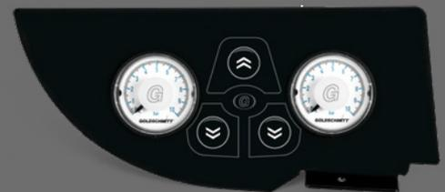
Um Ihnen eine permanente Kontrolle Ihres Luftfedersystems zu ermöglichen, bieten wir für viele Modelle **fahrzeugspezifische Cockpitblenden** an, die sich passgenau im Armaturenbrett vieler Fahrzeugtypen integrieren lassen. Alternativ sind ein Universalbedienteil oder eine Ausführung für ISO-genormte Radioschächte erhältlich.
