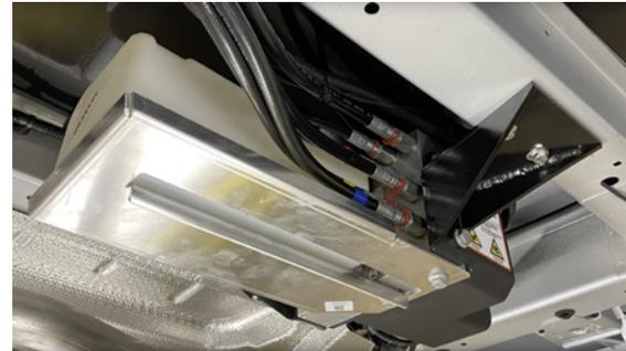
Das Hydraulikaggregat der HLC® Smart wurde speziell für die Unterflurmontage konstruiert.
