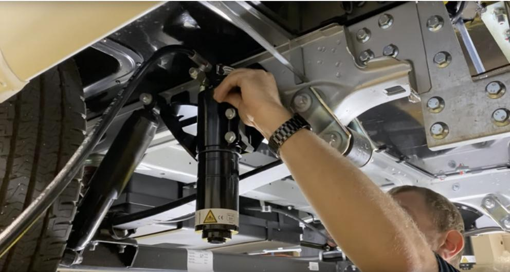
Die Hydraulikzylinder werden mit speziellen Konsolen am Fahrzeugrahmen befestigt.
