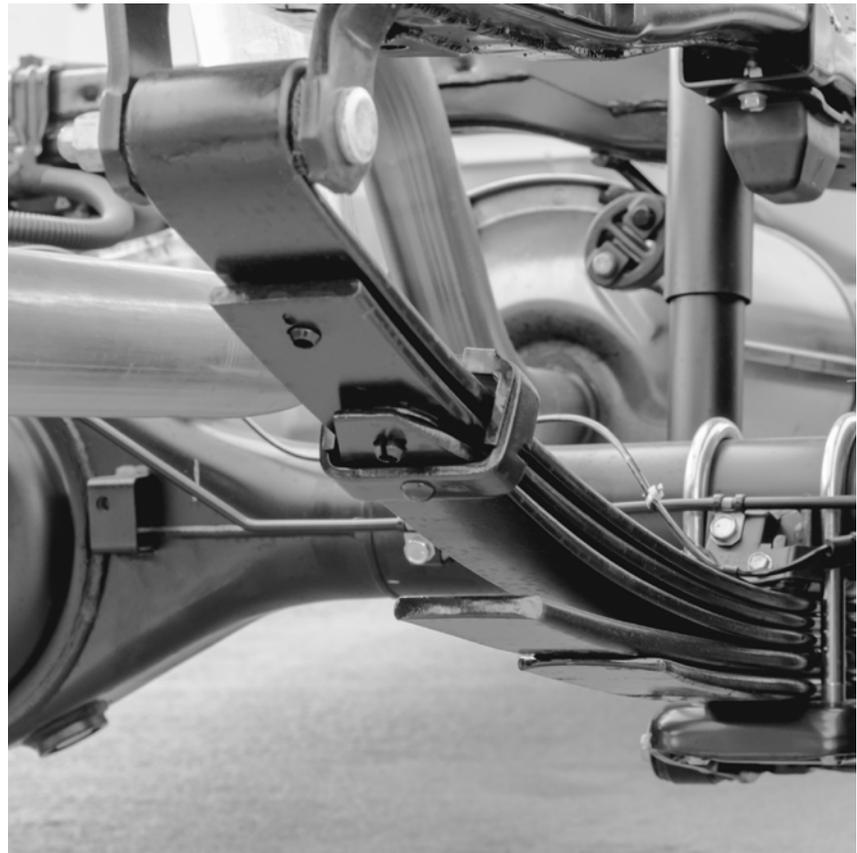
Unsere nachrüstbaren Blattfedern bringen wieder Spannung und Federkraft in Ihr Fahrzeug. Hochwertiger Stahl und speziell ausgewalzte Federenden sorgen für eine bessere Federung und somit für verringerte Seitenwindanfälligkeit, bessere Kurvenstabilität und einfacheres Handling. Durchhängende Federpakete, die durch schwere Lasten und Materialermüdung hervorgerufen werden, errei-
